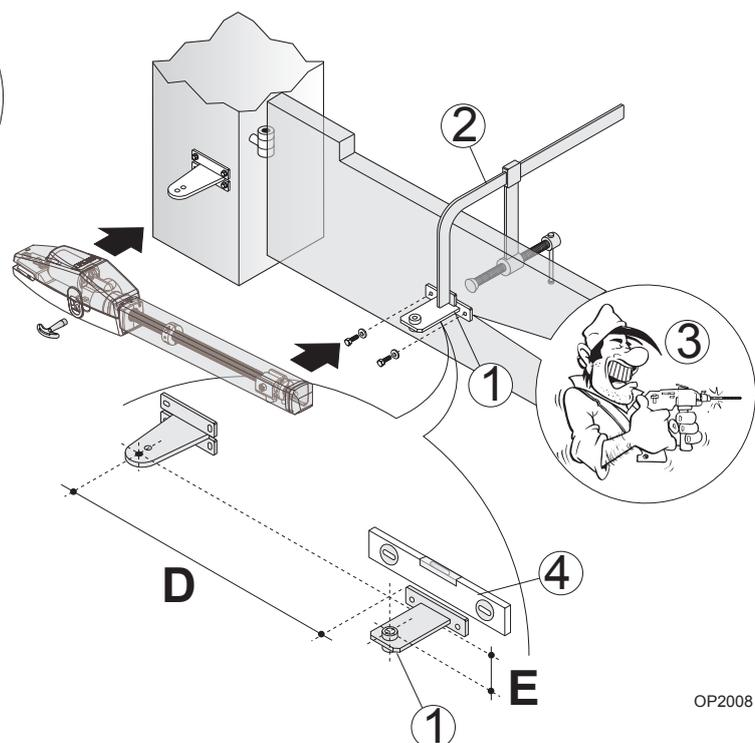
Il valore di E deve essere appena inferiore (10 mm) di D (interasse massimo) per permettere una migliore regolazione dei finecorsa.
